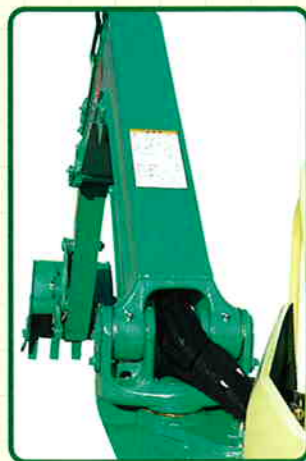
油圧ホースの損傷を防ぐため、ブームに内装した外観スッキリのインナーブーム
